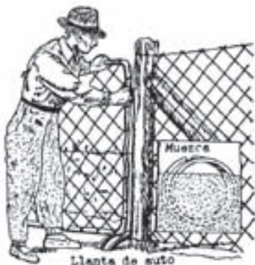
La llanta vieja de auto permite, con una muestra en la pestaña, el cierre de una porterita.
