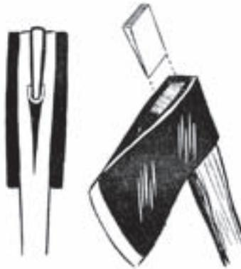
**Afirmando el hacha de montar.** Un buen sistema para ajustar la cabeza de un hacha es clavar un clavo a través de la cuña que se va a utilizar antes de introducirla en el mango. Al colocar la cuña, el clavo se dobla porque tiende a volver a su posición natural, clavándose entonces en el mango del hacha. Esto impedirá que este se mueva y se separe de la cabeza.
