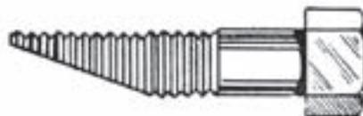
**Roscas obstruidas.** Se pueden limpiar fácilmente la cavidad y los filetes de una rosca ciega obstruida, utilizando un bulón al que se le efectúa un corte en forma de bisel.
