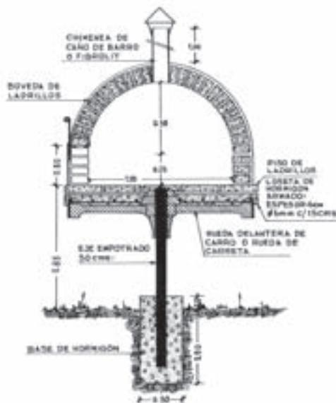
HORNO MONTADO SOBRE RUEDA. Corte
