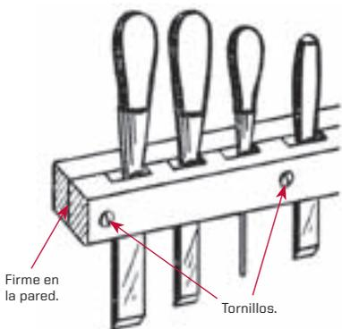
**Soporte para las herramientas.** Puede fabricarse un pequeño soporte de madera para los formones, escoplos, gubias y otras herramientas del taller. El trozo de madera posterior se adherirá firme en la pared, mientras que el anterior podrá removerse fácilmente al aflojar los tornillos que lo unen al primero.
