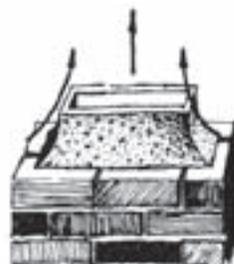
Se facilita el tiraje construyendo, a la salida de la chimenea, superficies curvas.
