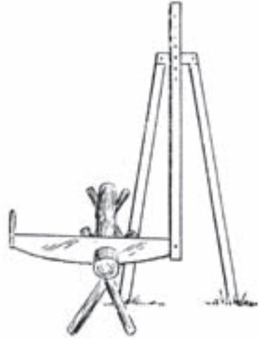
**Sierra para ser manejada por un hombre solo.** Se puede construir esta sierra con un armazón de madera en forma de A y con dos brazos en cruz en la parte superior formando la estructura. Se le agrega una tabla de dos por dos, sujeta por un perno que pasa a través del brazo horizontal, el cual actúa como péndulo, y varios agujeros a ser ubicados en lo alto del péndulo para permitir ajustarlo.
