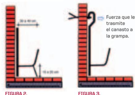
A efectos de tener más libre el pavimento para la extracción y el corrimiento de las brasas, se puede colocar un modelo de canasto que sustituya las patas delanteras por dos grampas amuradas que resistan la tendencia al vuelco. A su vez, cuanto más separadas del piso estén colocadas estas grampas, menos esfuerzo tendrán que soportar (fig. 3).
