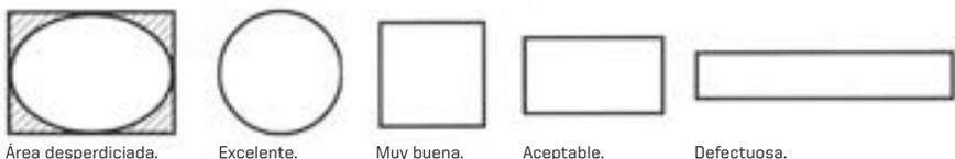
FIGURA 13. Área de circulación de humo. Formas del ducto.
