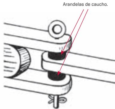
**Cómo evitar el traqueteo en la barra de remolque de un tractor.** El traqueteo que produce el pasador de enganche entre el tractor y el remolque puede eliminarse si se colocan dos arandelas de caucho sobre el pasador. Estas arandelas pueden hacerse perforando agujeros en tacones de caucho.
