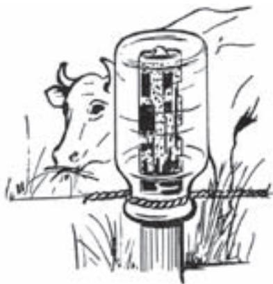
**Aislador de emergencia.** Una botella de leche u otro envase de cuello ancho servirá de aislador provisorio en las cercas o alambrados con corriente eléctrica, usándola de la manera que ilustra la lámina.
