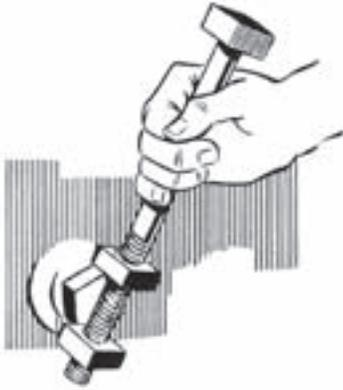
**Una llave improvisada.** Esta llave rápida de hacer y ajustar consiste en dos tuercas que corren sobre el extremo de un perno o tornillo grande, entre las cuales se coloca el objeto que se quiere destornillar.
