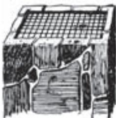
El tejido metálico no debe colocarse al ras de la salida, pues se destruye fácilmente con el hollín.
