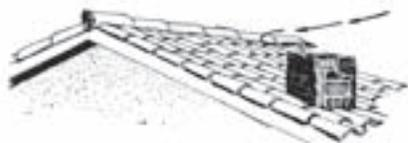
La chimenea construida más baja que la cumbrera provoca corrientes de aire hacia abajo, introduciendo el viento en la estufa.
