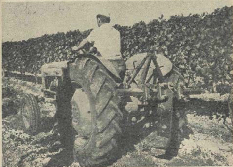
Momento en que se procede a pasar el subsolador, en cultivos en espalderas altas, implemento que permite remover la tierra hasta 65 centímetros de profundidad
