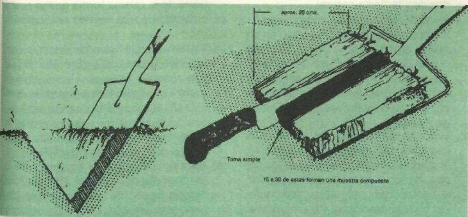
Fig. 1 - Forma de obtención de tomas con pala.
