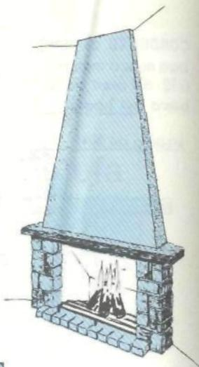
je. Este escalón interior se extiende a lo largo de la garganta y su profundidad será de 10 a 20 cm mayor que el diámetro del conducto de la chimenea.
