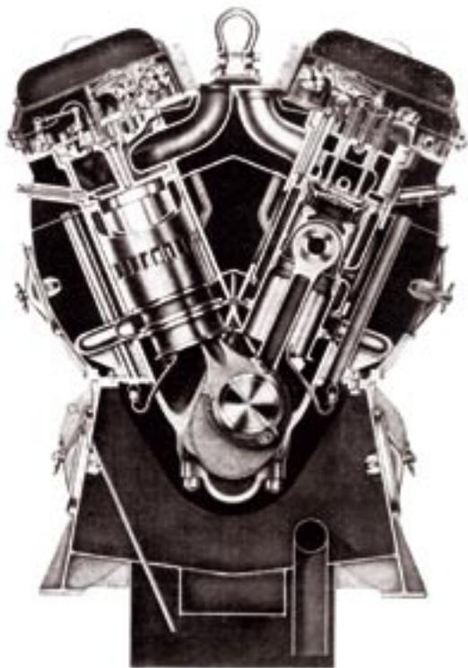
Vista en corte de un diesel GM, ejemplar típico capaz de funcionar con combustible vegetal.
