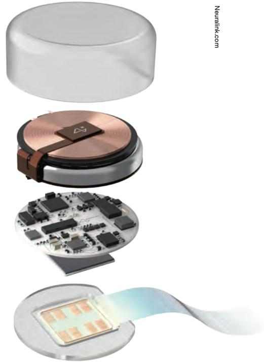
LINK: Dispositivo que procesa y transmite las señales neuronales. Cada hilo contiene muchos electrodos para detectar señales neuronales y está conectado al implante
